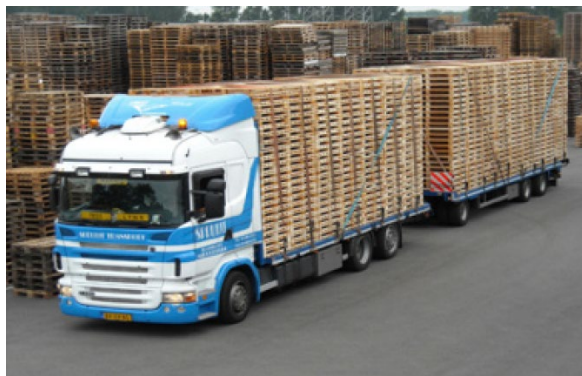
משטחי עץ משטחים רתומים בעזרת רצועות ריתום. יש לקשור, ברצועה של 2 טון לפחות, כל קבוצת משטחים בנפרד.
