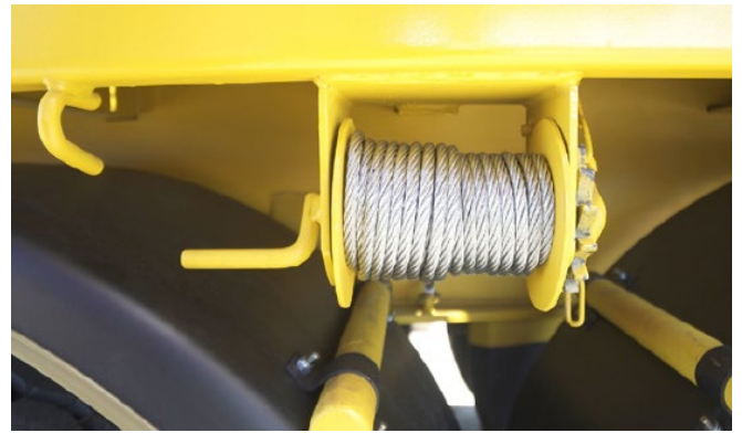
מותחן לכבל פלדה משמש לעיגון מטען לפי סוג המטען ומשקלו
