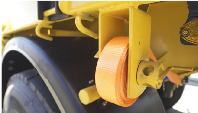
מותחן מובנה לרצועה בגוף הנתמך מתחבר לרצועות קשירה לפי סוג הרצועה וסוג המטען
